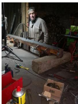
Le montant des travaux de peinture de la lame de déneigement est de 3 000E TTC. Auparavant Samy Raspail a remis en état le matériel, travaux de carrosserie, remplacement des pièces abimées par la rouille, changement des caoutchoucs de frottement...
